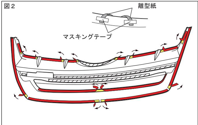
⚠注意：外気温が15℃以下の場合、両面テープの接着力が低下しているので、テープ面及び接着面をドライヤー等で温めて(約40℃)取付けて下さい。
