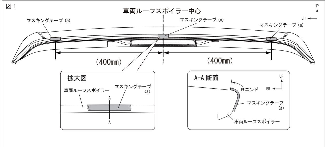
1. 図1のように車両ルーフスポイラー後端Rエンドの位置にマスクングテープでマーキングする。
