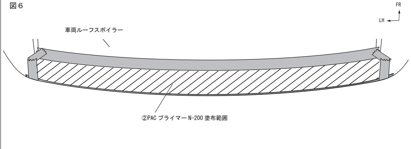
6. 図 6 のように①ルーフスポイラーの両面テープ貼り付け部（上図斜線部）に②PACプライマー N-200を塗布する。
