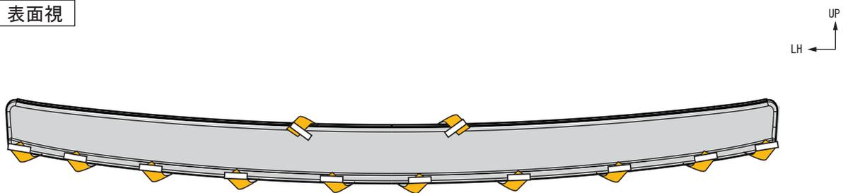
7. 図 7 のように①の両面テープの離型紙を矢印の方向に剥がしてマスキングテープ等で表側に貼り付ける。（12箇所）
