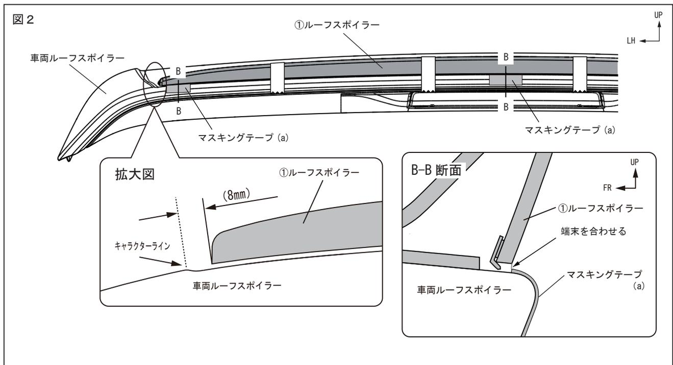
2. 図2のようにマスクングテープに①ルーフスポイラーの端末を合わせて、車両ルーフスポイラー段差のRエンドから左右の距離が均等になるように位置を決めマスクングテープで仮固定する。
