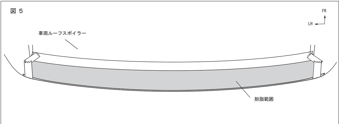
5. 図 5 のように①ルーフスポイラーの両面テープ貼り付け部の汚れを取り除き、イソプロピルアルコール（IPA）でマスキングテープの内側を一方向に拭いて脱脂する。
